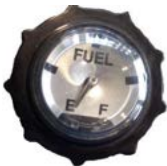
Indicatore del livello del serbatoio meccanico: indica il livello del gasolio sul serbatoio.
