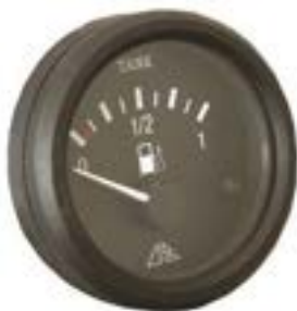
Indicatore del livello del serbatoio: indica il livello del gasolio nel serbatoio (optional)
