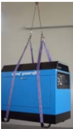
Fig. 7.1 : Sollevamento dei gruppi elettrogeni per mezzo di carrello elevatore o tramite fasce di sollevamento adeguate.
