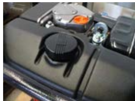
Fig. 4.4 : Punto di rifornimento carburante
