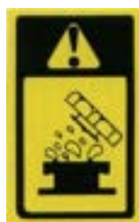
PERICOLO LIQUIDO REFRIGERANTE
